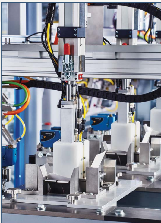
Aufrichter für die Faltschachtelzuschnitte.
